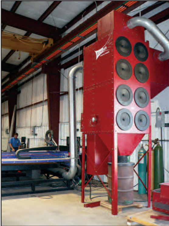
RP8 Con atrapa chispa, colecta humos de una mesa de corte con plasma
